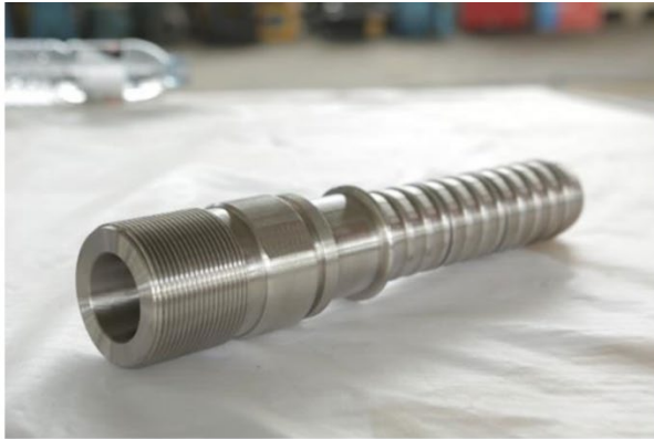
Figura 4.5 - Rosca interior de mandril A1 en la izquierda y rosca exterior de mandril A2 en la derecha.
