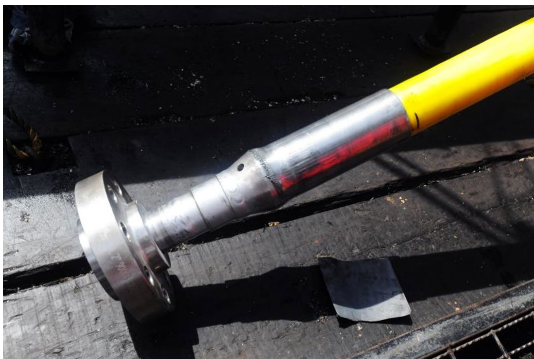
Figura 4.9 – Adaptación de brida de extremo de tubería de conexión de acero inoxidable con cuello soldado.
