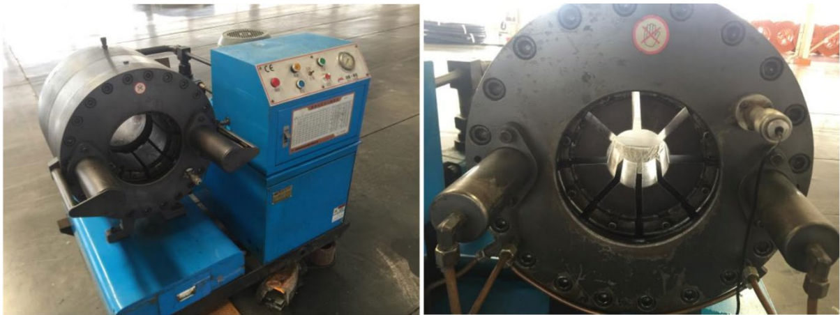
Figura 4.14 – Maquina para conectores KM-91F de 6 pulgadas (diámetro exterior 90-198mm).
