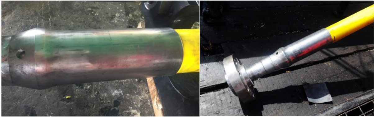
Figura 4.16 – Bidas de extremo después del proceso de estampado.
