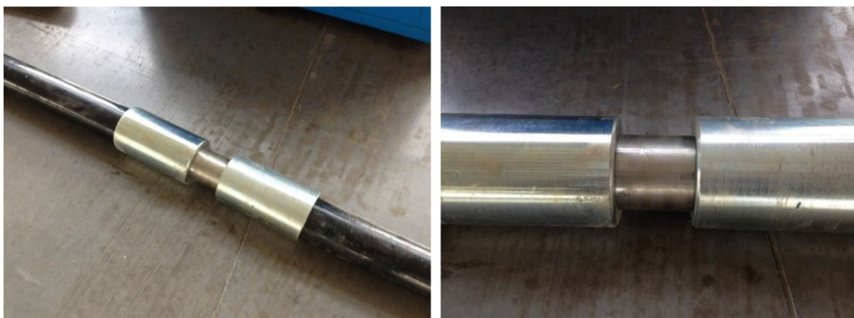
Figura 4.4: Conexión integrada Buckle-press de una pieza.
