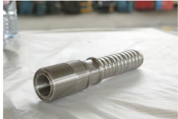
Figura 4.5 - Rosca interior de mandril A1 en la izquierda y rosca exterior de mandril A2 en la derecha.
